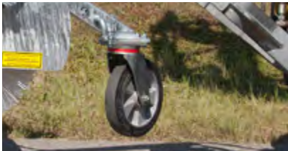
Roues directionnelles stables Ø 250 mm
