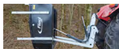
2 vérins pour un angle de basculement optimal de 111°
