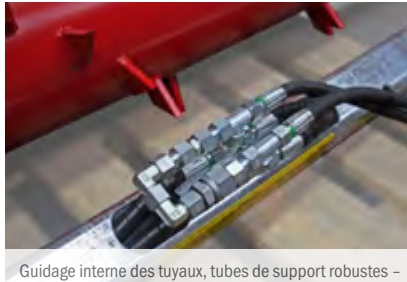
Guidage interne des tuyaux, tubes de support robustes – protection optimale des tuyaux
