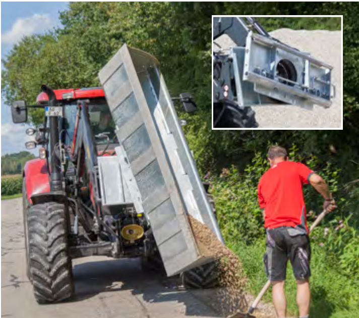
Avec godet pour matériaux lourds, pour le déversement précis de matériaux en vrac (non compris dans la livraison)
