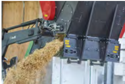
3 rouleaux de dosage avec couteaux
