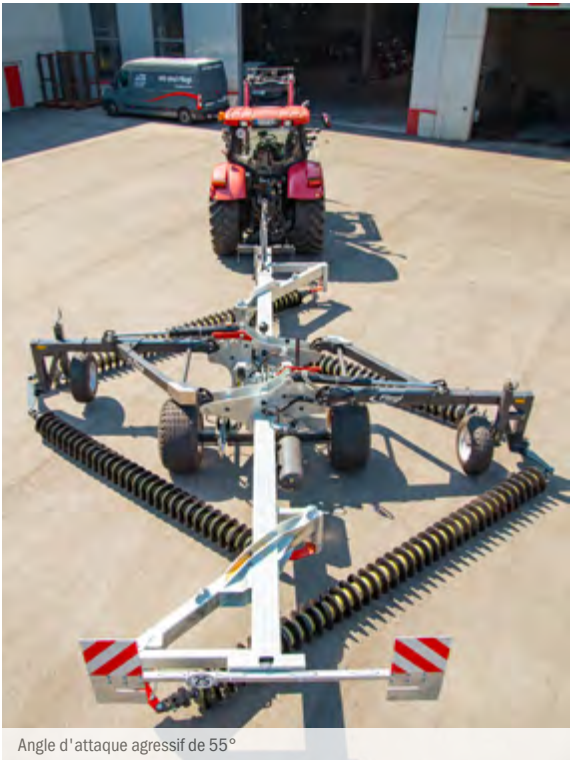
Angle d'attaque agressif de 55°
