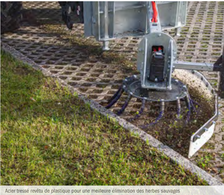
Acier tressé revêtu de plastique pour une meilleure élimination des herbes sauvages
