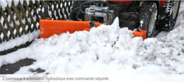
2 panneaux à orientation hydraulique avec commande séparée
