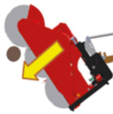
Remarque : coupez toujours les branches épaisses du haut vers le bas pour éviter un blocage des lames de scie !
