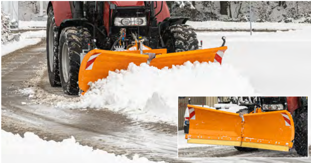
Deux panneaux à orientation hydraulique avec commande séparée permettent une position en équerre, en chasse-neige ou en V
