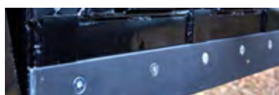
Racleur boulonné – pas de boulons en saillie
