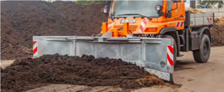
Avec racleurs en caoutchouc, longue durée de vie grâce aux câbles en acier moulés
