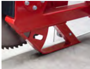
L'arceau de sécurité empêche la lame de scie la plus basse d'entrer en contact avec le sol.
