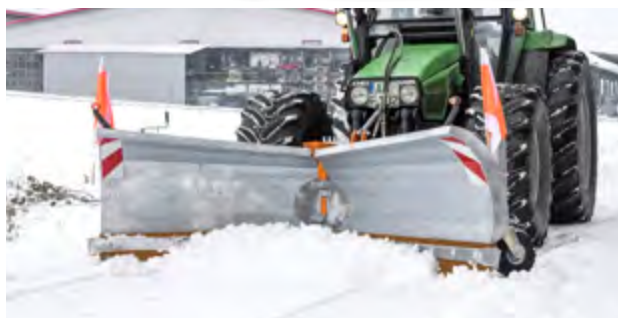
Deux panneaux à orientation hydraulique avec commande séparée permettent une position en équerre, en chasse-neige ou en V
