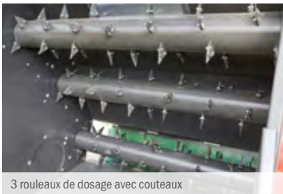
3 rouleaux de dosage avec couteaux
